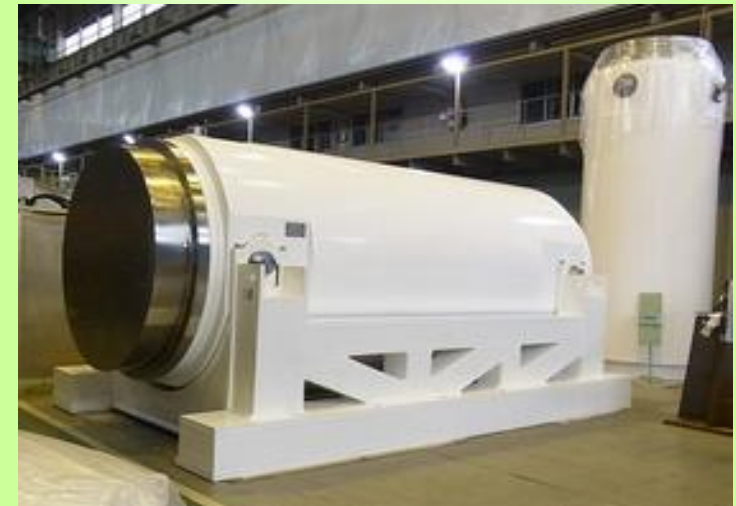
使用済み燃料の貯蔵容器 (中性子遮蔽材)
