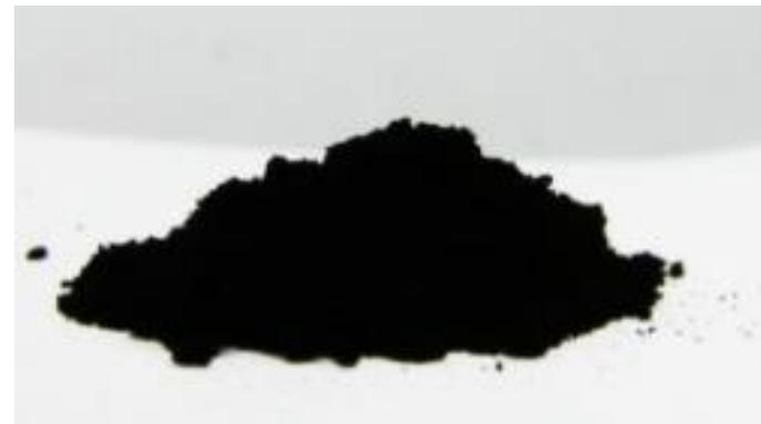
開発した燃料電池触媒の外観
